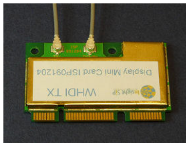
図2 高速無線通信技術「WHDI」に対応した通信モジュール
