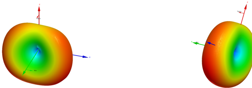
Figure 42 : Rayonnement de l'antenne à 7 GHz
