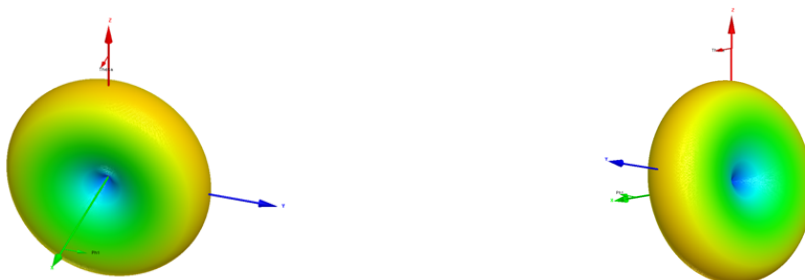
Figure 34 : Rayonnement de l'antenne à 3 GHz
