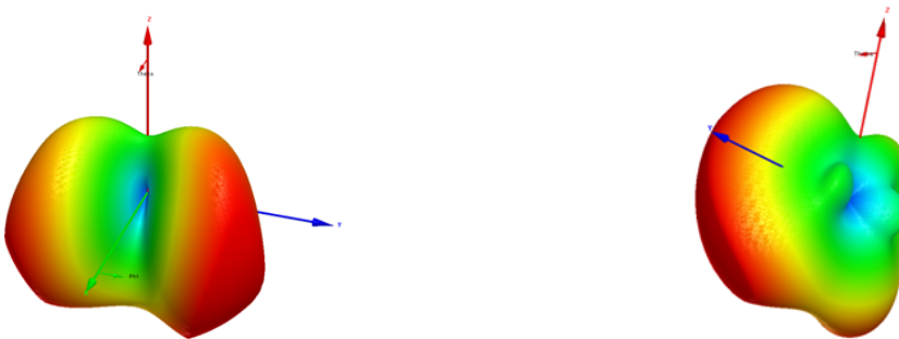
Figure 43 : Rayonnement de l'antenne à 10.6 GHz
