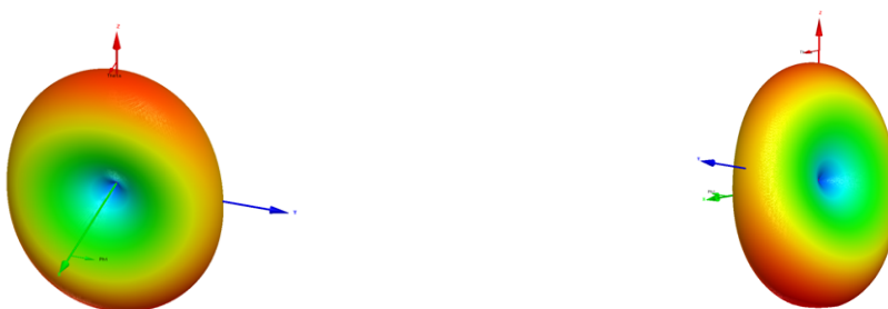
Figure 35 : Rayonnement de l'antenne à 7 GHz
