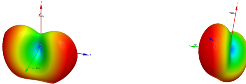
Figure 39 : Rayonnement de l'antenne à 7 GHz
